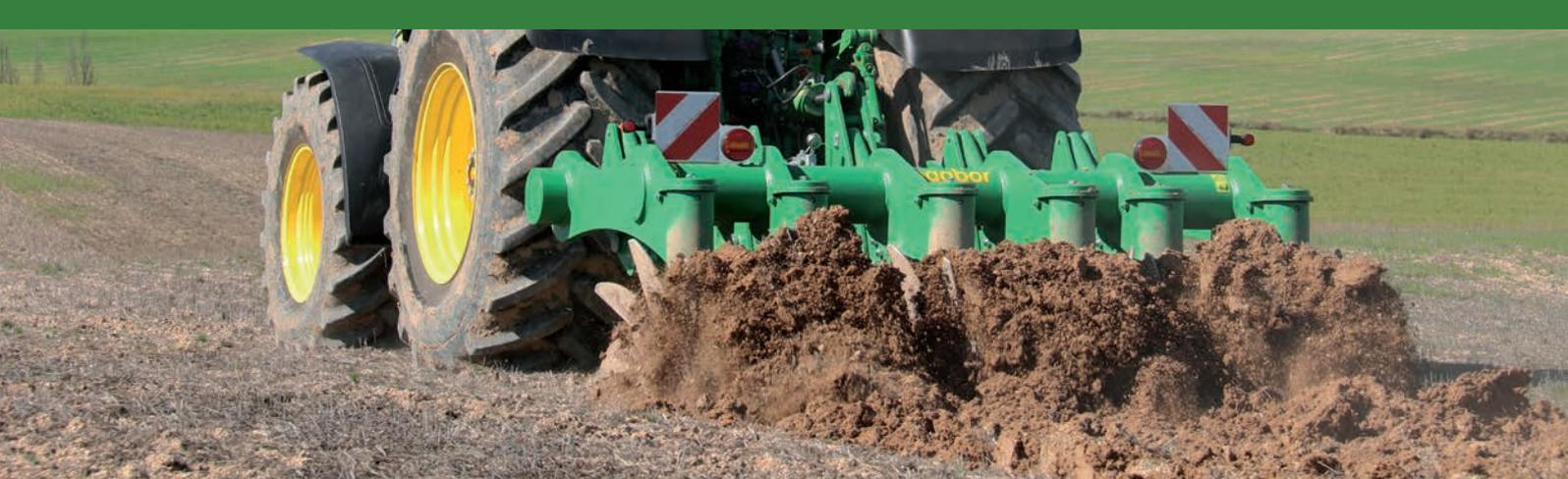
La **araña baabor** es una máquina novedosa (**dos aperos en uno**) que se compone de un subsolador de 5 rejonos hidroneumáticos y de 6 arañas, las cuales pueden variar su ángulo fácilmente sin herramientas y en tan solo unos minutos.
