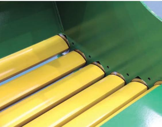
Nuestro **innovador sistema de perfil lobular en los ejes de cribado** va más allá que cualquier otra criba de ejes del mercado. Con un movimiento silencioso, exento de vibraciones, agita el material en el interior del cazo suavemente. Esto permite el cribado de materiales sensibles a la rotura como los residuos de demolición que contienen ladrillos, madera, piezas de hierro, etc. Además de los finos propios de la construcción, sin triturar ninguno de estos.
