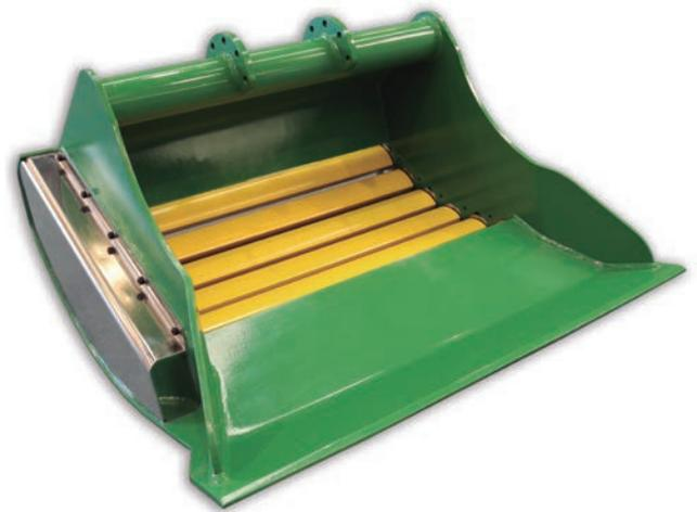
La criba lobular 'baabor' es un cazo de excavación equipado para **trabajos de cribado**. Mediante accionamiento hidráulico el cazo permite cribar el material en su interior, desalojando los finos de tamaño inferior a la distancia entre ejes y manteniendo en su interior sólidos más grandes. Dado su perfil, similar a un cazo de excavación, permite todos los trabajos habituales de este tipo de cazo.
